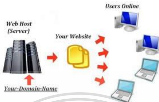
ภาพที่ 2.5 การเว็บไซต์ที่สร้างขึ้นใหม่จะไปฝากไว้กับผู้ให้บริการ หรือที่เรียกว่าเว็บโฮสติ้งพร้อมกับการจดทะเบียนโดเมนเนม
