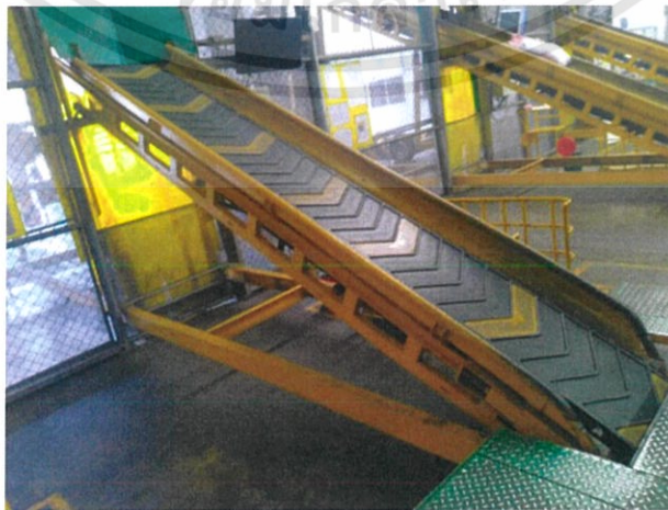
รูปที่ 2.34 สายพานลำเลียงกระสอบอาหารขึ้นรถบรรทุก
