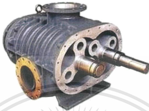
รูปที่ 2.26 ปั๊มลมประเภทใบพัดหมุน (Roots Air Compressor)
