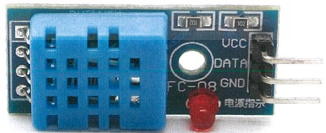
รูปที่ 3.11 DHT11 Humidity and Temperature Sensor
