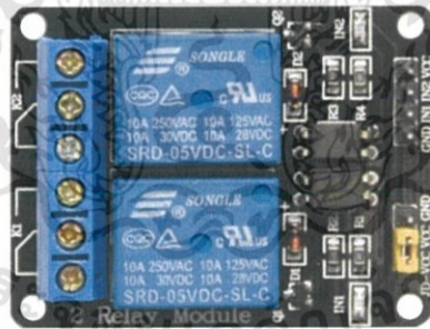
รูปที่ 3.13 Relay Module 5V 250V/10A 2 Channel
