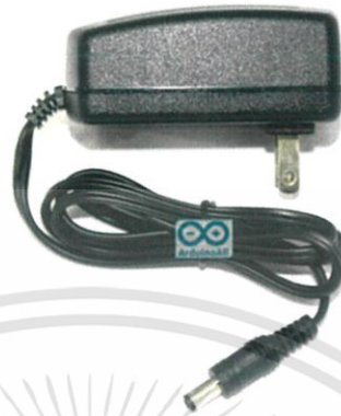
รูปที่ 3.12 Adapter 220V to 5V
