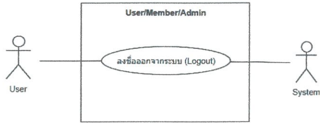
ภาพที่ 3.42 Use Case Diagram ระหว่าง User กับ System ในการออกจากระบบ
