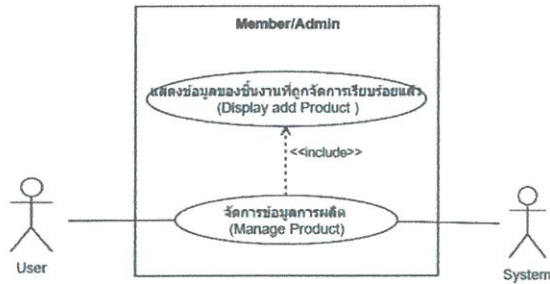
ภาพที่ 3.48 Use Case Diagram ระหว่าง User (ที่มีสถานะ Admin/Member) กับ System ในการจัดการตัวชิ้นงาน(TrayID) ในหน้า check in /check out to WIP/check out fail/check out scrap
