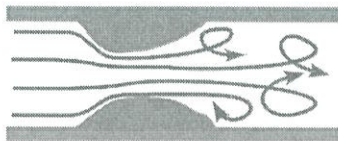
รูปที่ 4.6 ทิศทางการไหลของอากาศแบบปั่นป่วน (Turbulent flow) [33]
