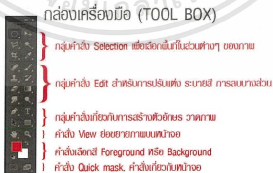
รูปที่ 2.3 แสดงการแบ่งกลุ่มเครื่องมือของกล่องเครื่องมือ
