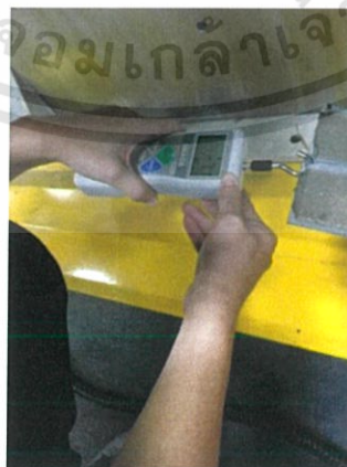
ภาพที่ 30 แสดงการวัดความตึงของ Liner
