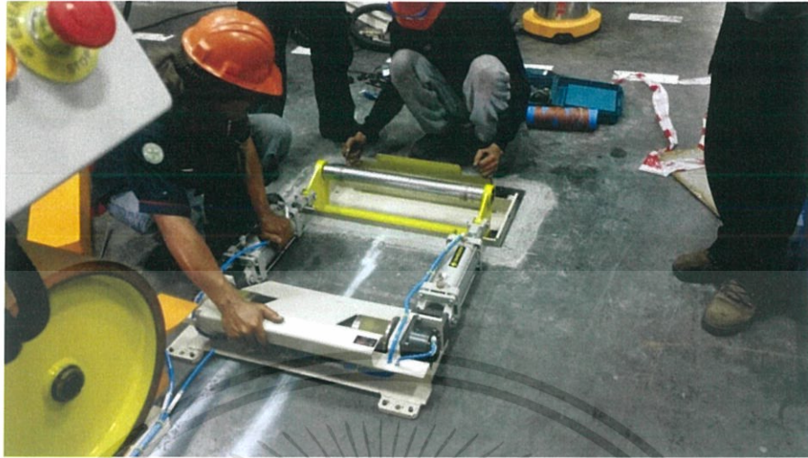
ภาพที่ 53 การวาง Let off ตามแนว Centerline
