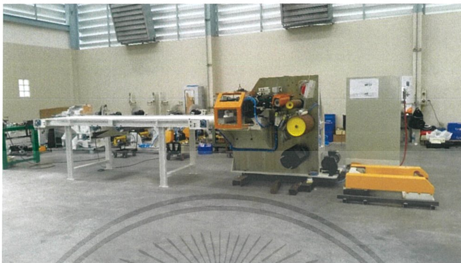
ภาพที่ 47 แสดงภาพ Cutting Conveyor , PKM และ Let off
