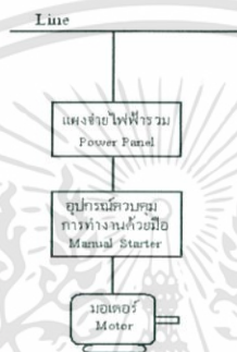
ภาพที่ 2.5 แผงการควบคุมมอเตอร์ด้วยมือ
