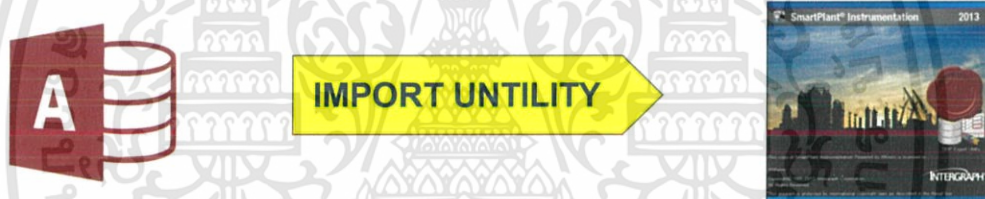
รูปที่ 3.9 คือการนำข้อมูลจาก Microsoft Access เข้าสู่ SPI ผ่านโมดูล Import Utility สำหรับการนำข้อมูลเข้าสู่โปรแกรม INTOOL ผ่านโมดูล Import Utility จะมีขั้นตอนดังนี้
