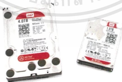
รูปที่ 2.2 ฮาร์ดดิสก์ไดรฟ์ขนาด 3.5 นิ้ว (ซ้ายมือ) และขนาด 2.5 นิ้ว (ขวามือ)
