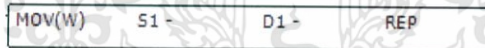
รูปที่ 2.21 สัญลักษณ์ Move ในโปรแกรม WindLDR
