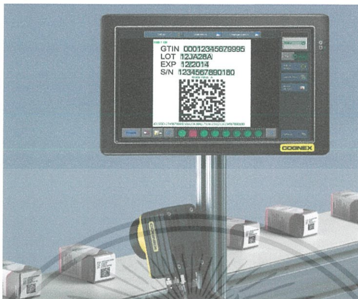
รูปที่ 2.14 ตัวอย่างของการใช้งานระบบแมชชีนวิชั่นในการตรวจสอบความถูกต้องของ QR Code [ที่มา: https://www.cognex.com/ko-kr/company/press-releases/2013/cognex-launches-new-version-of-identification-and-label-verification-software ]
