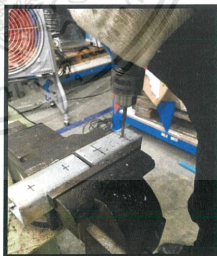
ภาพที่ 3.18 การตัดและเจาะรูยึดท่อของตัวสัฟพอร์ต
