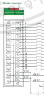
รูปที่ 2.16 ตัวอย่าง Digital Input Cards (BMXDDI1602) (a) และการเชื่อมต่ออุปกรณ์ภาคอินพุต (b)
