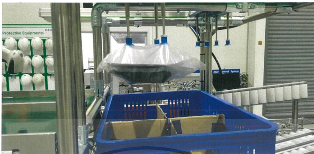
รูปที่ 4.5 Vacuum pad ทำหน้าที่ดูดจับคู่มือขึ้นมาจากถ່อง
