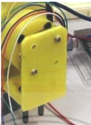
รูปที่ 3.3 โครงสร้างตัวยึด Encoder
