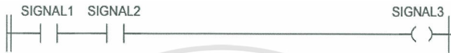
รูปที่ 2.12 ตัวอย่างแลตเตอร์ไดอะแกรมแสดงการทำงานของคำสั่งคอนแทคแบบปกติเปิด
