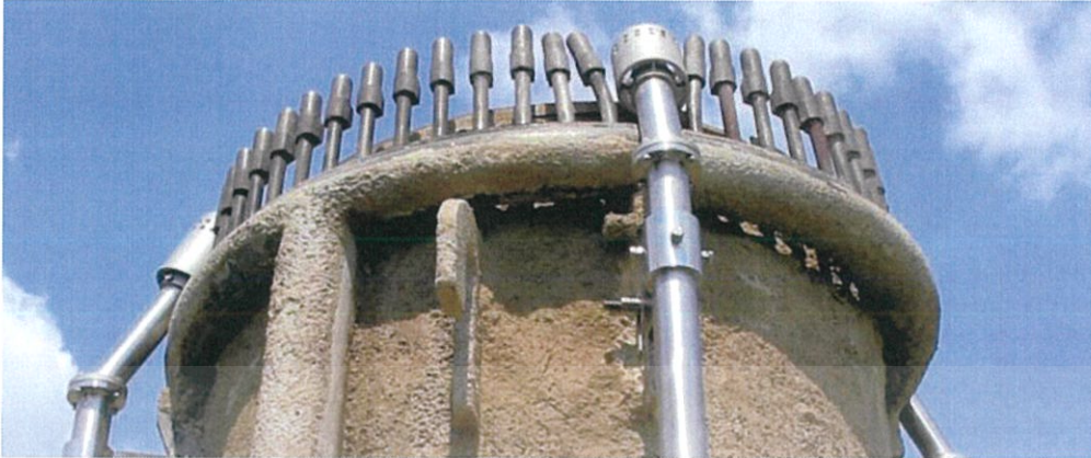
รูปที่ 2.10 ตัวอย่างส่วนประกอบของ Pilot Burners และ Ring Steam Burner
