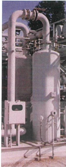
รูปที่ 2.5 ตัวอย่างและการทำงานของ Liquid Seal
