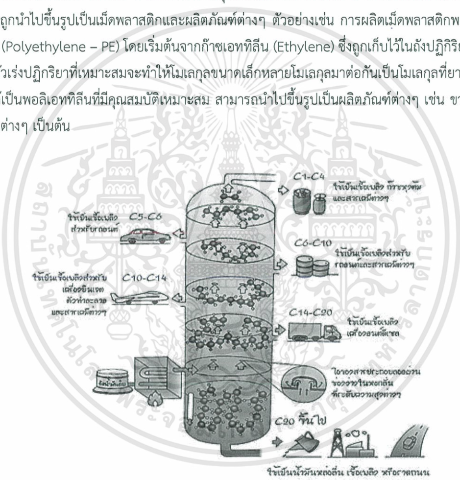
รูปที่ 2.1 กระบวนการกลั่นน้ำมันดิบ
