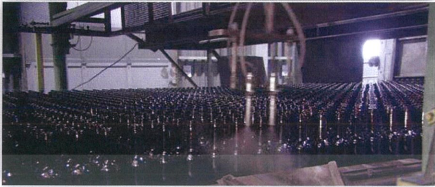
ภาพที่ 4.2 เครื่องฉีดน้ำยาเคลือบผิวพิเศษ
