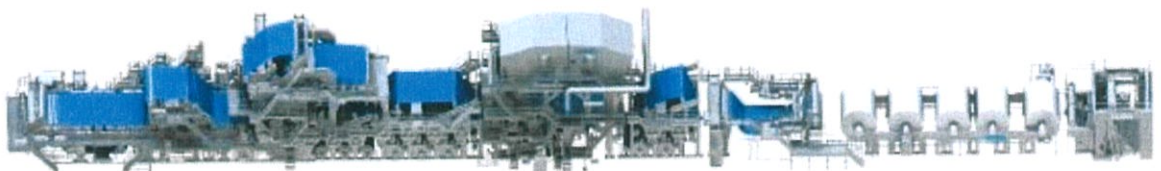
รูปที่ 2.2 เครื่องจักรผลิตกระดาษ (Paper Machine)
