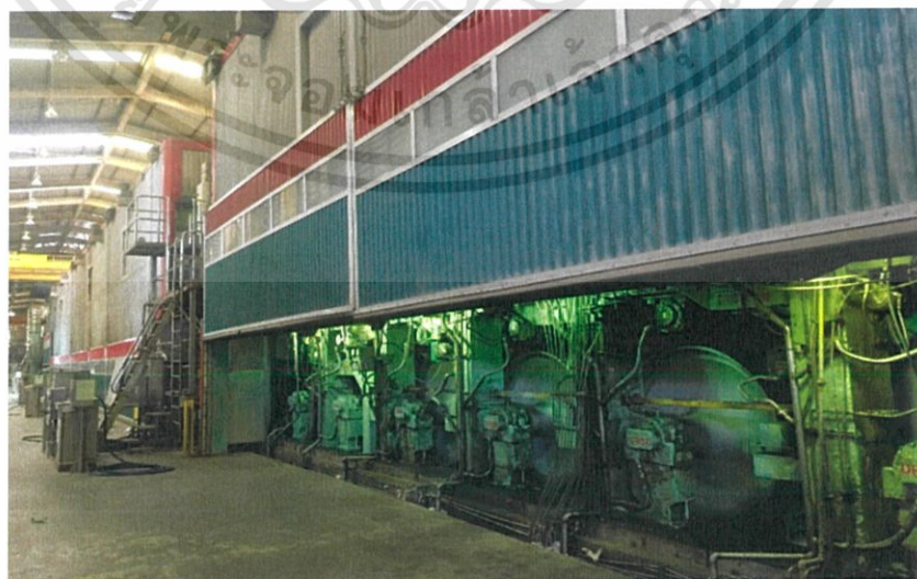
รูปที่ 2.6 เครื่องจักรผลิตกระดาษ ส่วนที่เรียกว่า Dryer Section
