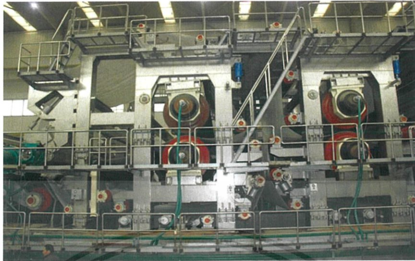
รูปที่ 2.5 เครื่องจักรผลิตกระดาษ ส่วนที่เรียกว่า Press Section
