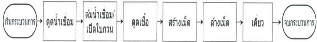
รูปที่ 2.3 ผังงานแสดงขั้นตอนการทำงานของระบบช่วยเคียวหม้อเคียวตั้ง
