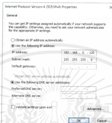
รูปที่ 3.28 หน้าจอกำหนด IP address ในคอมพิวเตอร์
