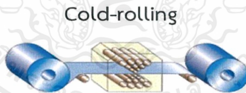
รูปที่ 2.5 กระบวนการรีดเย็นของเหล็กกล้าไร้สนิมแบบย้อนกลับไปมา (โพสโค-ไทยน็อคซ์, 2557)
