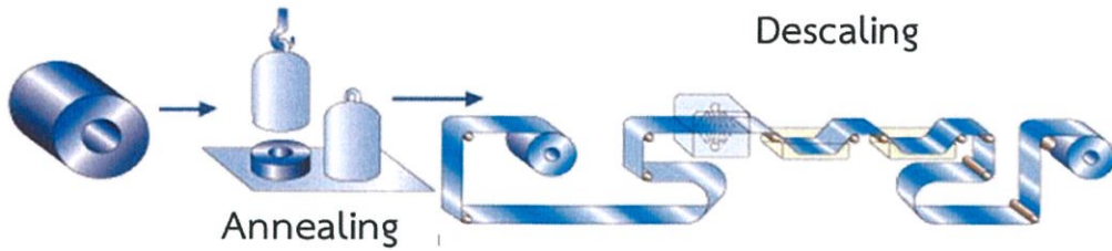
รูปที่ 2.4 กระบวนการอบอ่อนและการกำจัดสเกลออกไซด์ (โพสโค-ไทยน็อคซ์, 2557)
