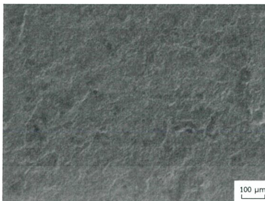
รูปที่ 4.7 ผิวของเหล็กกล้าไร้สนิมเกรด 304L ที่ผ่านการอบอ่อนที่อุณหภูมิ 1,175 องศาเซลเซียส เป็นเวลา 5 นาที หลังการกัดกรวดด้วยกระแสไฟฟ้าในสารละลายโซเดียมซัลเฟตที่ค่า ศักย์ไฟฟ้า 1.0 V (Ag/AgCl)
