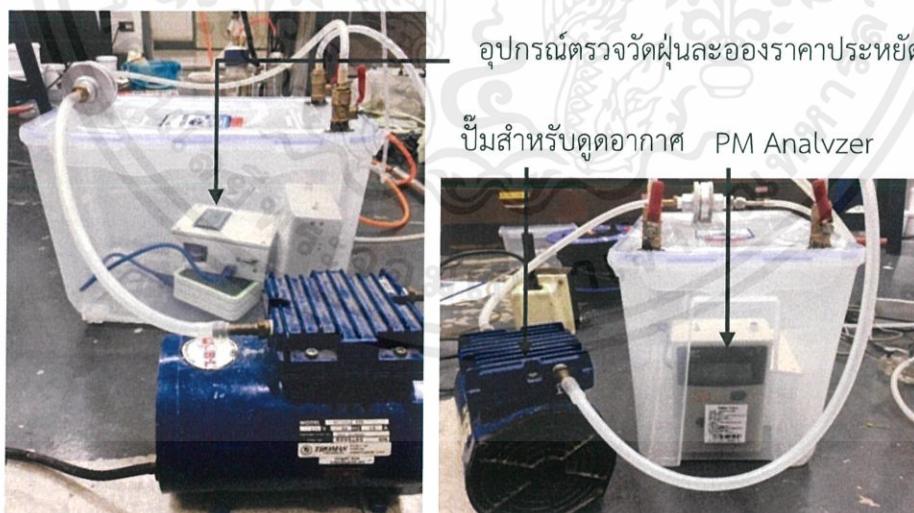
รูปที่ 3.5 การทดสอบอุปกรณ์ที่พัฒนาขึ้นในกล่องสะอาดที่มีอากาศบริสุทธิ์หมุนเวียน
