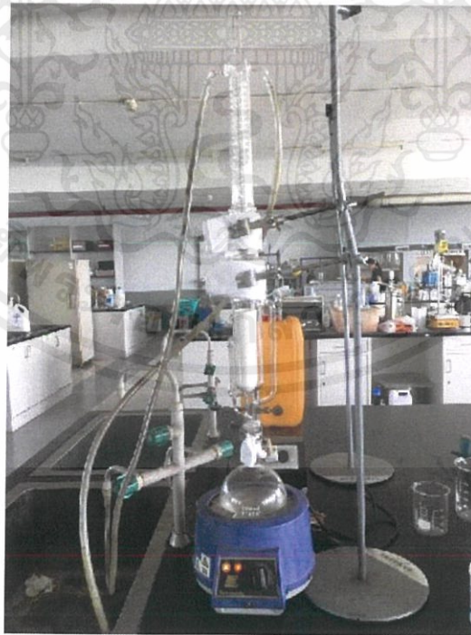
รูปที่ จ.2 ชุดเครื่องแก้วสกัดแบบซ็อกเก็ต (Soxhlet Extractor) สำหรับใช้สกัดด้วยอะซิโตน
