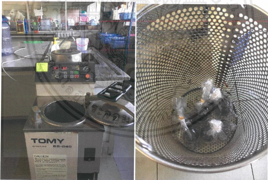
รูปที่ จ.4 หม้อต้มความดันสูง (Autoclave) สำหรับใช้ในวิธีเคลซอนลิกนิน
