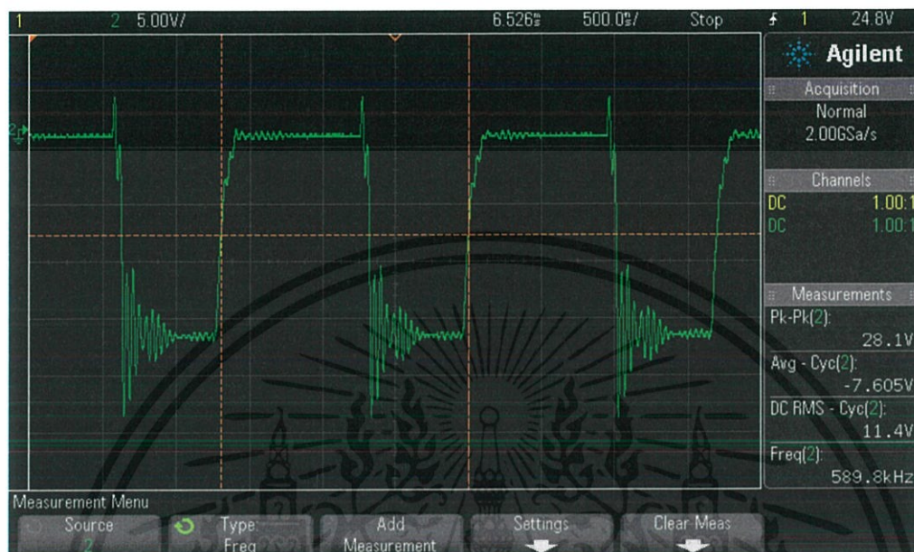
รูปที่ 4.10 รูปสัญญาณของมอสเฟต(MOSFET)Q1:ขณะทำการชาร์จแบตโดยวัดระหว่างขาเดรน(Drain)และซอส(Source)ที่เวลา 500 ns/cm
