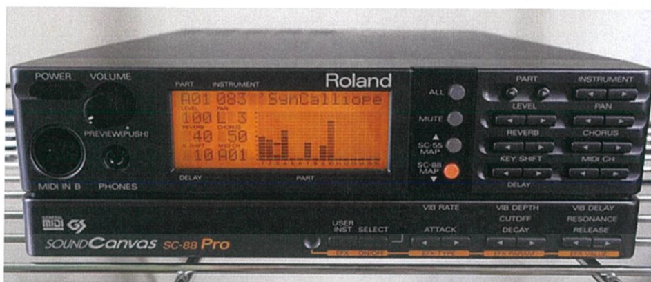
ภาพเครื่อง MIDI Synthesizer หรือ เครื่องสังเคราะห์เสียงที่ใช้ในโปรเจก Musical Instrument Digital Interface Drum รุ่น Roland Sound Canvas SC-88vl
