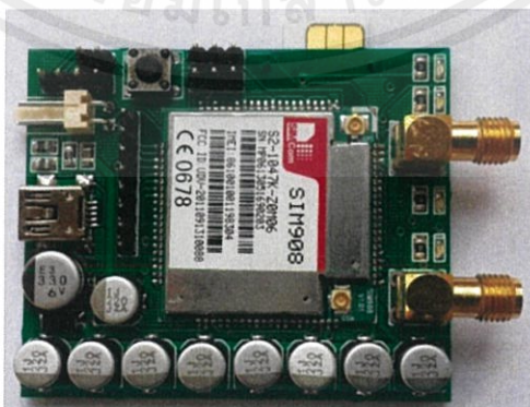
รูปที่ 3.1 ตัวอย่าง GSM Module SIM908
