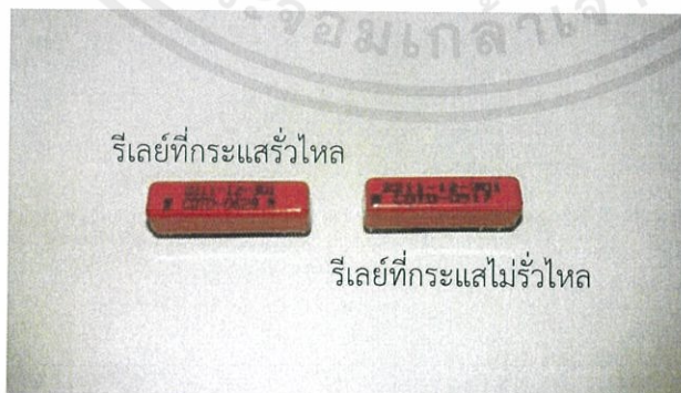
รูปที่ 3.7 รีเลย์ที่เกิดกระแสรั่วไหลและไม่รั่วไหล
