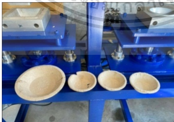
ภาพที่ ง.12 นำภาชนะออกจากแม่พิมพ์ตรวจสอบความเรียบร้อย
