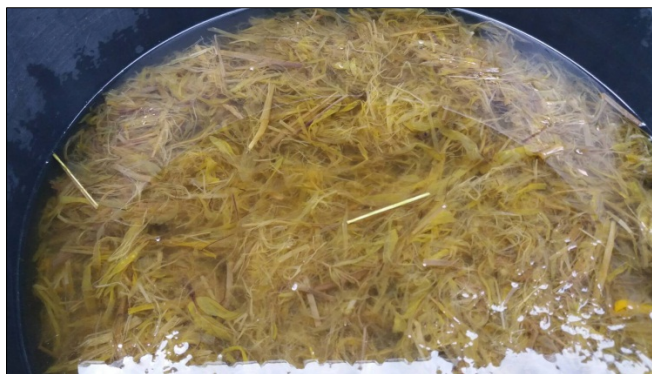
ภาพที่ 4.6 เยื่อของต้นข่าที่ผ่านการต้ม 3 ชั่วโมง
