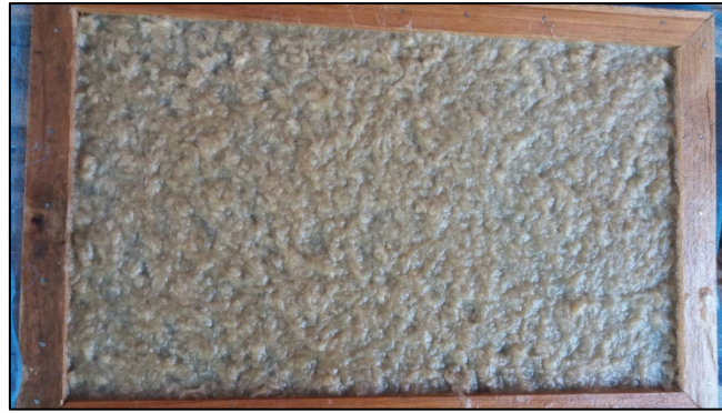
ภาพที่ 4.12 นำแม่พิมพ์พักไว้ในร่ม 2-3 ชั่วโมงก่อนนำไปฝังแดดให้แห้ง ที่มา : มนตรี คำยะ (2562)
