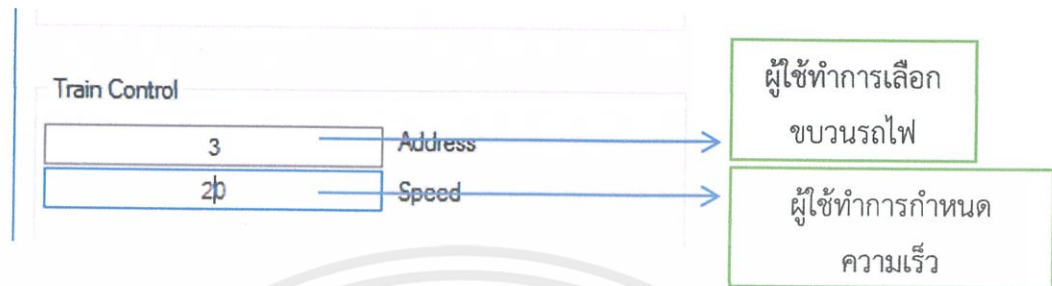
รูปที่ 3.5 การสั่งงานควบคุมชุดรถไฟจำลอง
