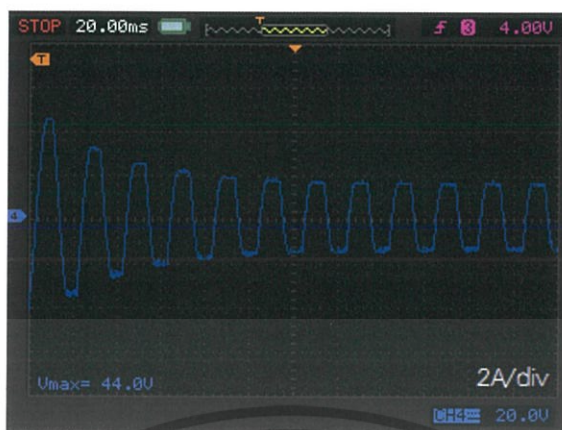
รูปที่ 5.8 รูปคลื่นกระแสที่ไหลในรีแอคเตอร์เอซีช่วงชาร์จจากการทดลอง
