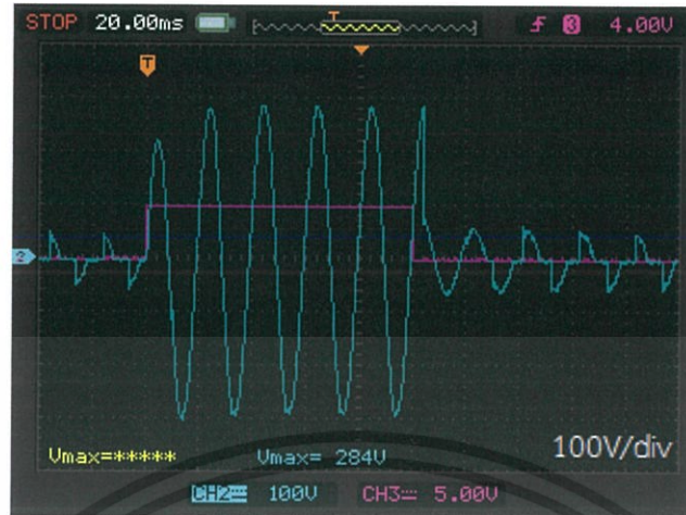
รูปที่ 5.17 รูปคลื่นแรงดันของรีแอคเตอร์เอซีจากการทดลอง
