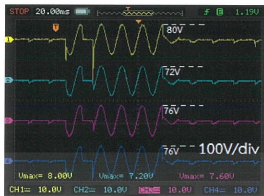
รูปที่ 5.24 รูปคลื่นแรงดันตกคร่อมไทรสเตอร์ T1 ของแต่ละเซลล์จากการทดลอง
