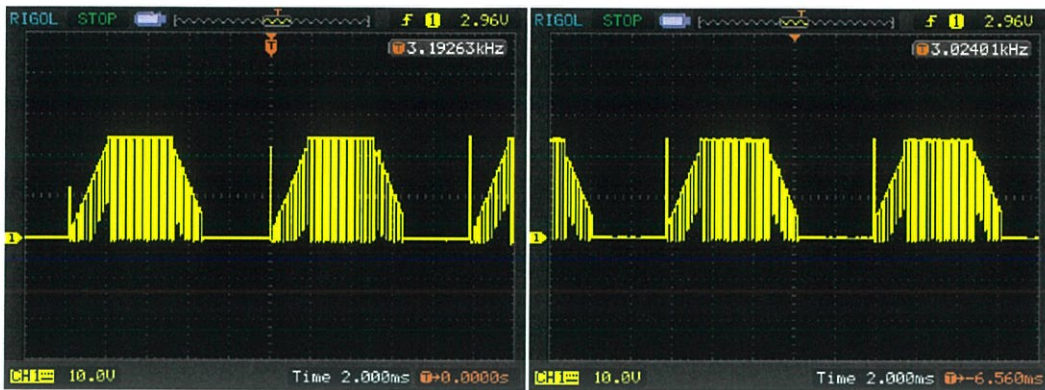
(ก) มีตัวตรวจจับ (ข) ปราศจากตัวตรวจจับ รูปที่ 4.9 แรงดันเฟสแบบมีตัวตรวจจับกับปราศจากตัวตรวจจับที่คิวตี้ 0.8
