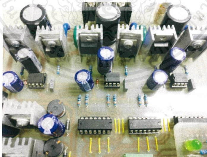
รูปที่ 3.22 วงจรบูทสเตรปที่ใช้สำหรับขับเคลื่อนมอเตอร์ที่ได้ออกแบบ
