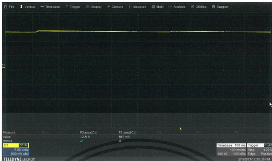
รูปที่ 4.7 กราฟแรงดันของแผ่นเพียโซอิเล็กทริกเมื่อผ่านวงจรเรียงกระแส และตัวเก็บประจุ
