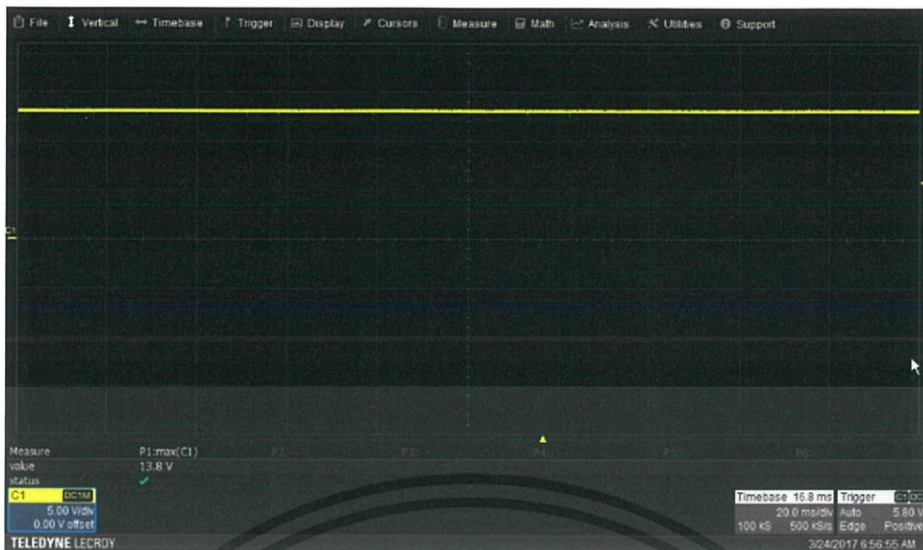
รูปที่ 4.11 กราฟแรงดันของแผ่นเพียโซอิเล็กทริกเมื่อผ่านวงจรเรียงกระแส ตัวเก็บประจุ วงจรดาร์ลิ่งตัน และวงจรเพิ่มแรงดัน
