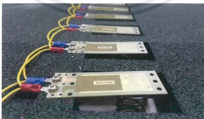
รูปที่ 4.4 ด้านล่างของแผ่นเพียโซอิเล็กทริกจะมีการนำสปริงมาวางรองไว้
