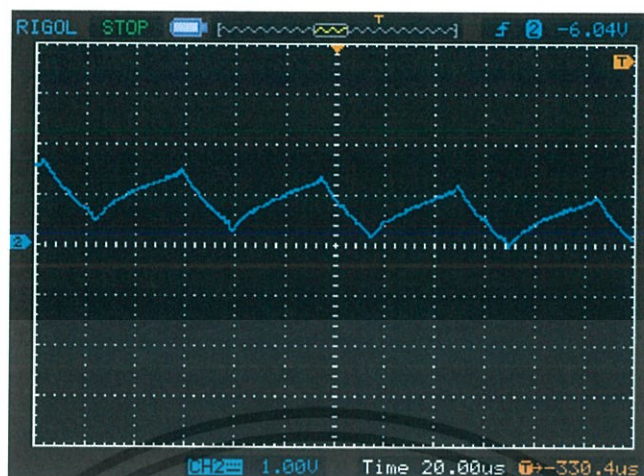
รูปที่ 4.13 กราฟกระแส Output ของวงจร DC Chopper ที่วัดจากScope(Duty0.6)
