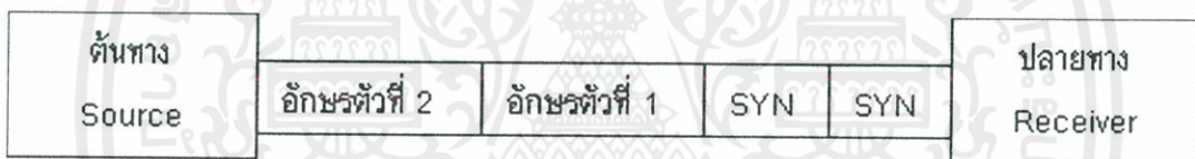
รูปที่ 2.21 ตัวอย่างการใช้อักขระซิง 2 ตัวในการสื่อสารแบบซิงโครนัส
