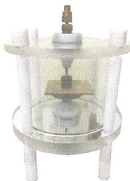
รูปที่ 3.21 ชุดทดสอบค่าความคงทนต่อแรงดันอิมพัลส์ฟ้าผ่าของเพรสบอร์ด
