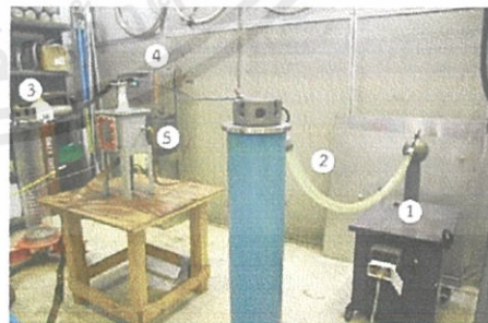
รูปที่ 3 วงจรทดสอบการเกิดดีสชาร์จบางส่วนในน้ำมันหม้อแปลง
