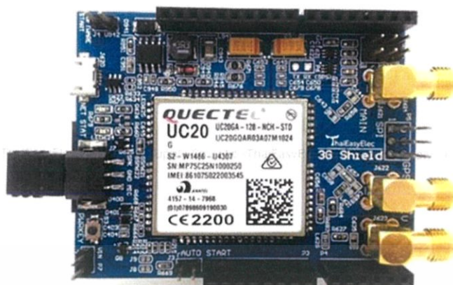
ภาพที่ 2.5 โมดูล 3G Shield (UC-20) (ที่มา : ThaiEasyElec)
