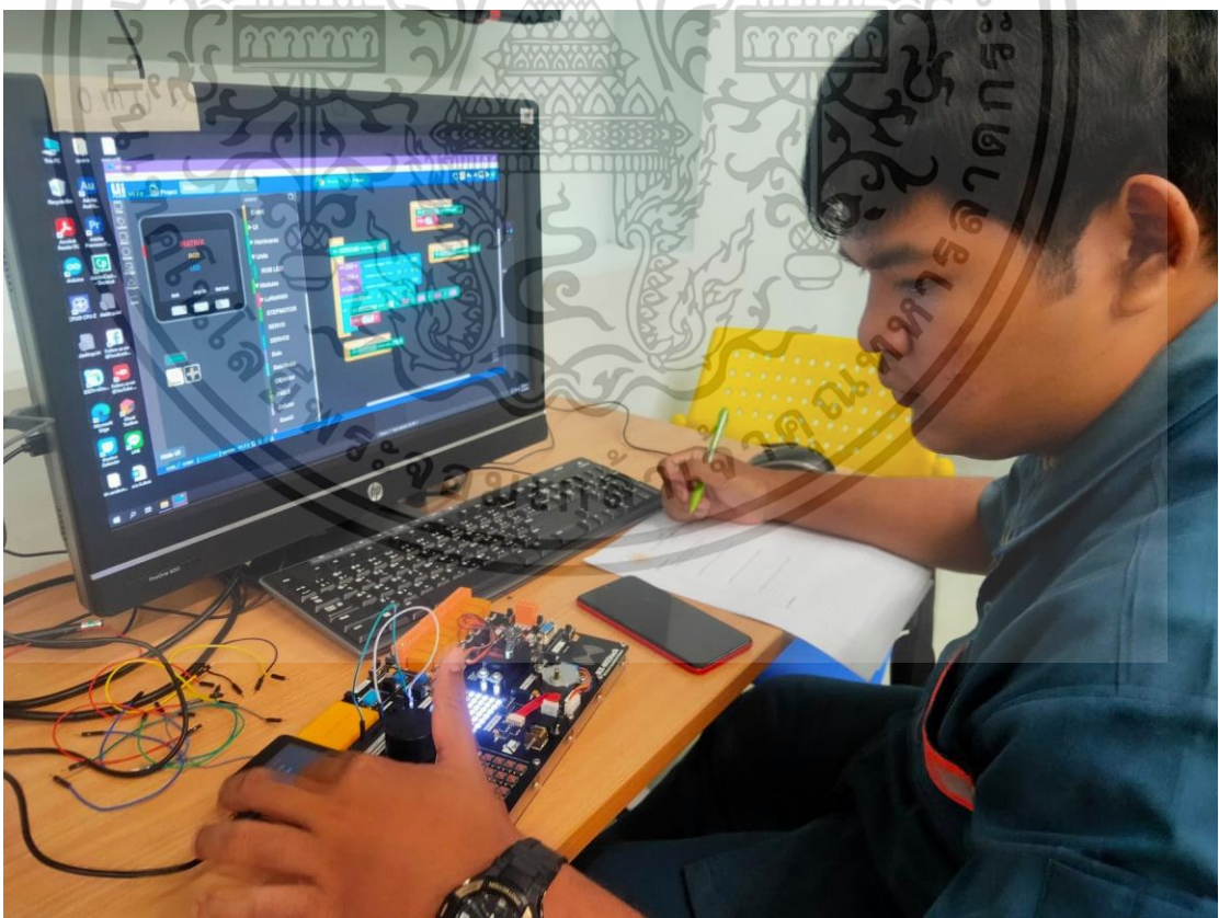
ภาพที่ ๓.๔ นักศึกษาทดลองใช้บอร์ดไมโครคอนโทรลเลอร์แบบสำเร็จรูปกับใบงาน
