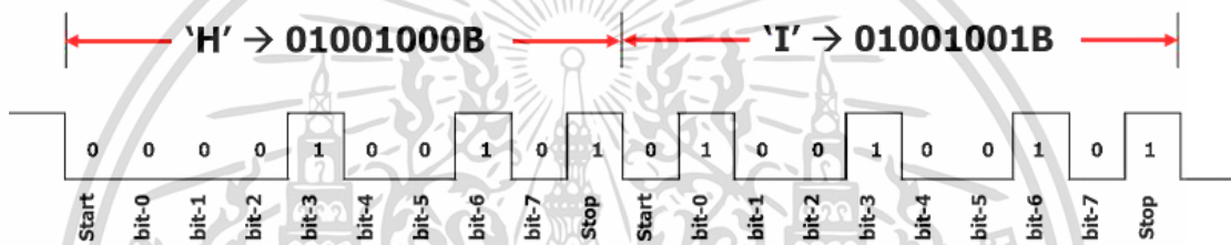
ภาพที่ 2.5 การส่งข้อมูล ASCII สื่อสารข้อมูลผ่านพอร์ตอนุกรมแบบอะซิงโครนัส ที่มา : https://blog.thaieasyelec.com/espino32-ch7-how-to-use-uart
