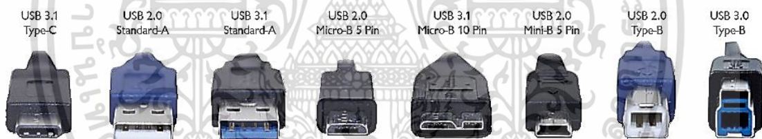
ภาพที่ 2.22 มาตรฐาน USB Connector Type
