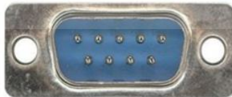
ภาพที่ 2.6 พอร์ตอนุกรม (DB9) PC ตัวผู้ (Male)
