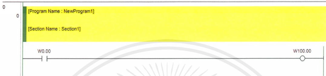
รูปที่ 4.10 ตัวอย่าง Ladder ที่มีส่วนของอินพุตและเอาต์พุต
