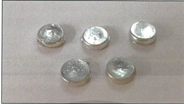
รูปที่ 3.22 ชิ้นงานที่ได้จากการหล่อด้วยแม่พิมพ์โลหะ
