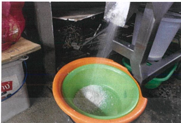
รูปที่ 3.11 การจับเวลาสำหรับการคำนวณหาอัตราการไหลของกากมะพร้าว
