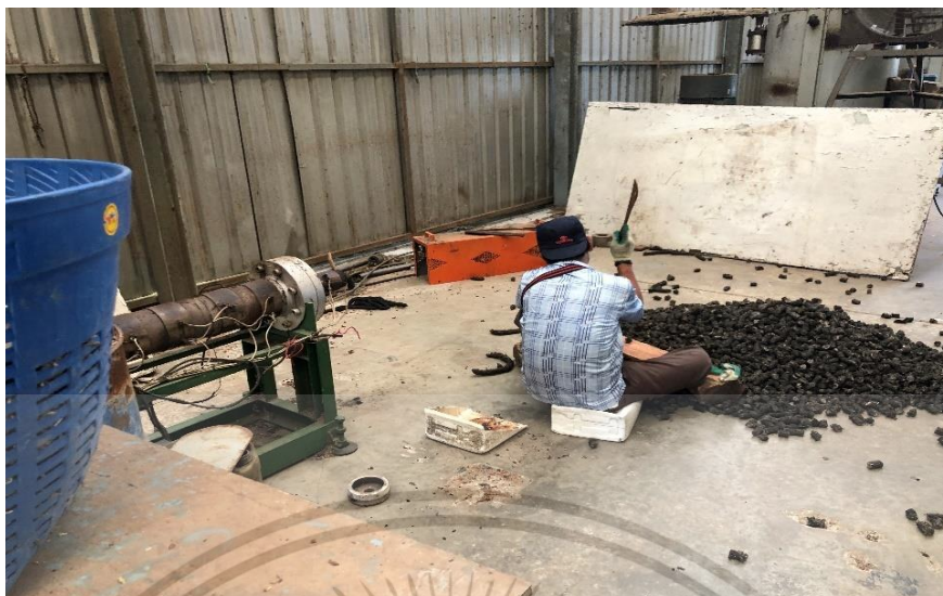
ภาพที่ 2.7 แสดงวิธีการผลิตเชื้อเพลิงขยะ (Refuse Derived Fuel: RDF)
