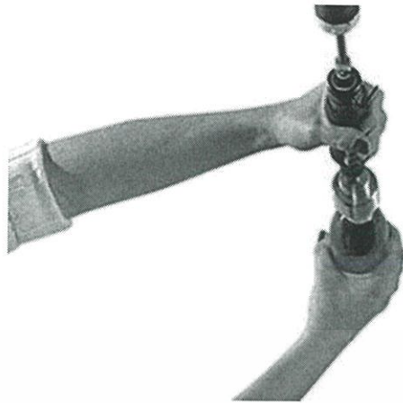
รูปที่ 2.9 เครื่องปิดฝาขวดด้วยมือแบบระบบนิวเมติก (ที่มา : www.apacks.com )
