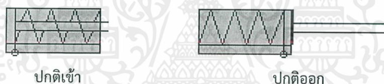
รูปที่ 2.35 สัญลักษณ์ของกระบอกสูบทางเดียวแบบปกติเข้าและปกติออก
