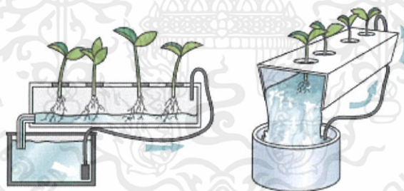
รูปที่ 2.1 การปลูกผักไฮโดรโปนิคส์ แบบ NFT (Nutrient Film Technique : NFT) [1]
