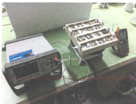
รูปที่ 4.22 แสดงการทดสอบเบื้องต้นของบล็อกโมดูลเทอร์โมอิเล็กทริก
