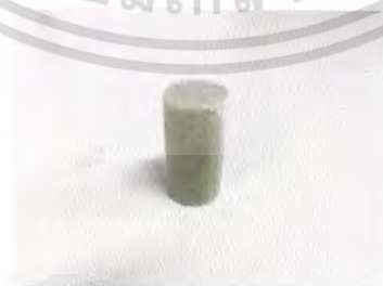
รูปที่ 3.6 แสดงแท่งเซลล์เทอร์โมอิเล็กทริก Al-doped ZnO หลังการเผาแข็ง
