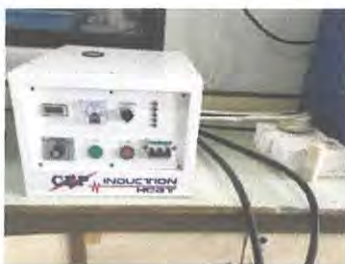
รูปที่ 3.9 เครื่องให้ความร้อนแบบเหนี่ยวนำ
