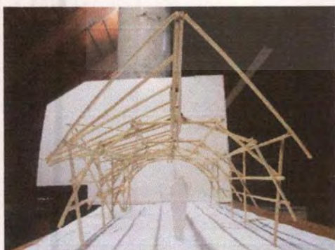
รูปที่ 7.7 รูปแสดงตัวอย่างโครงสร้างรับน้ำหนักตัวเอง แบบจำลองโครงสร้างศาลาที่ใช้โครงสร้าง Davinci Bridge ถ่ายเมื่อ มี.ย 2560
