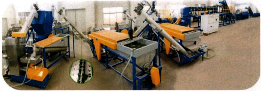
รูปที่ 3- 14 เครื่องหลอมแปรรูปเม็ดพลาสติก
